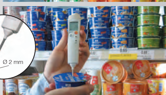
Misura della temperatura senza contatto e misura della temperatura interna degli alimenti
